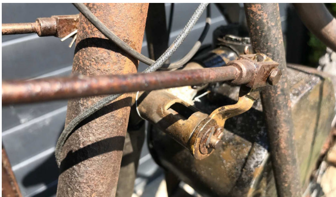
Hier zie je bediening en opening voor valse lucht
