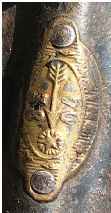
Het koperen plaatje in de velg met rijrichting
